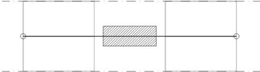
a) *scenario S1: caratterizzato dall'incendio di un autoveicolo commerciale in corrispondenza della mezzeria della trave o del solaio;*
